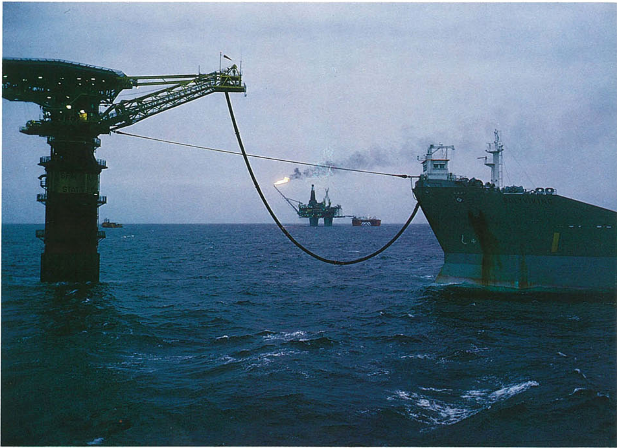
Øverst: Bøvelasting på Statfjord-feltet. M/T Polyviking henter råolje fra Statfjord B-bøyen. Nederst: Polyviking er kommet til Rotterdam, og lossingen er i gang. På havnen ser vi kranlekterne Balder og Hermod som har tatt mange løft i Statfjord-utbyggingen.
