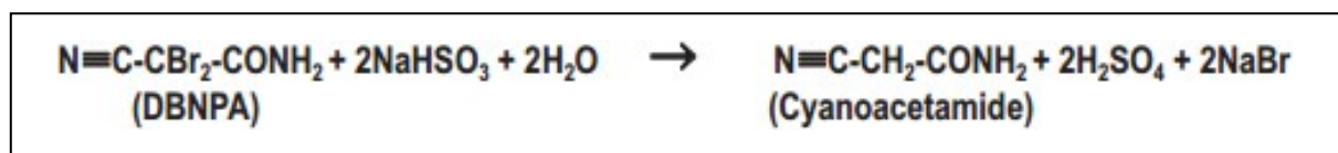
Figur 35. Reaksjonsligning for DNBPA og natrium bisulfitt ( \text{NaHSO}_3 , grønt kjemikalie).
