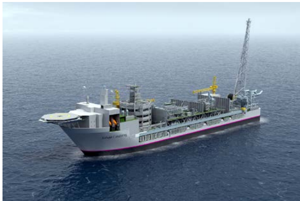
Figur 9 Havbunnsutbygging, produksjonsskip med prosessering, lagring og omlasting på feltet (FPSO)
