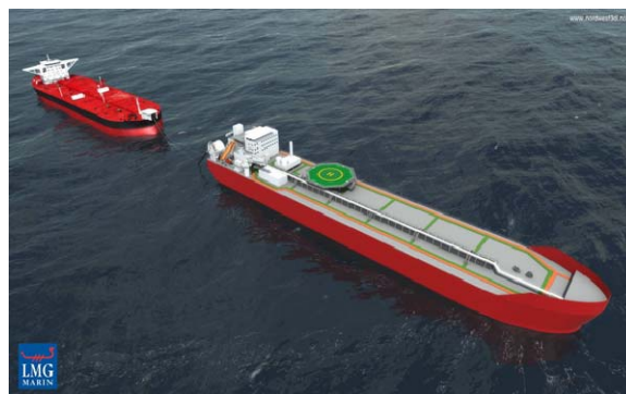
Figur 3-10 Dagny FSO med opplasting til skytteltanker
