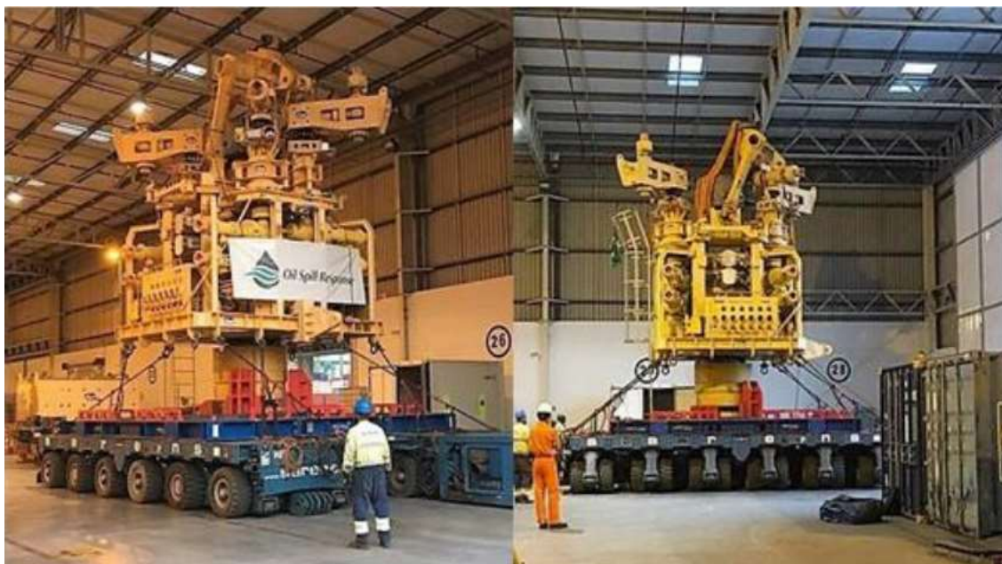
Figura 3-3 Sistema de taponamiento submarino en Río de Janeiro.
