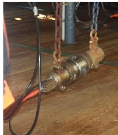
Figura 4. Esquema típico de una fuente de energía de aire comprimido.
