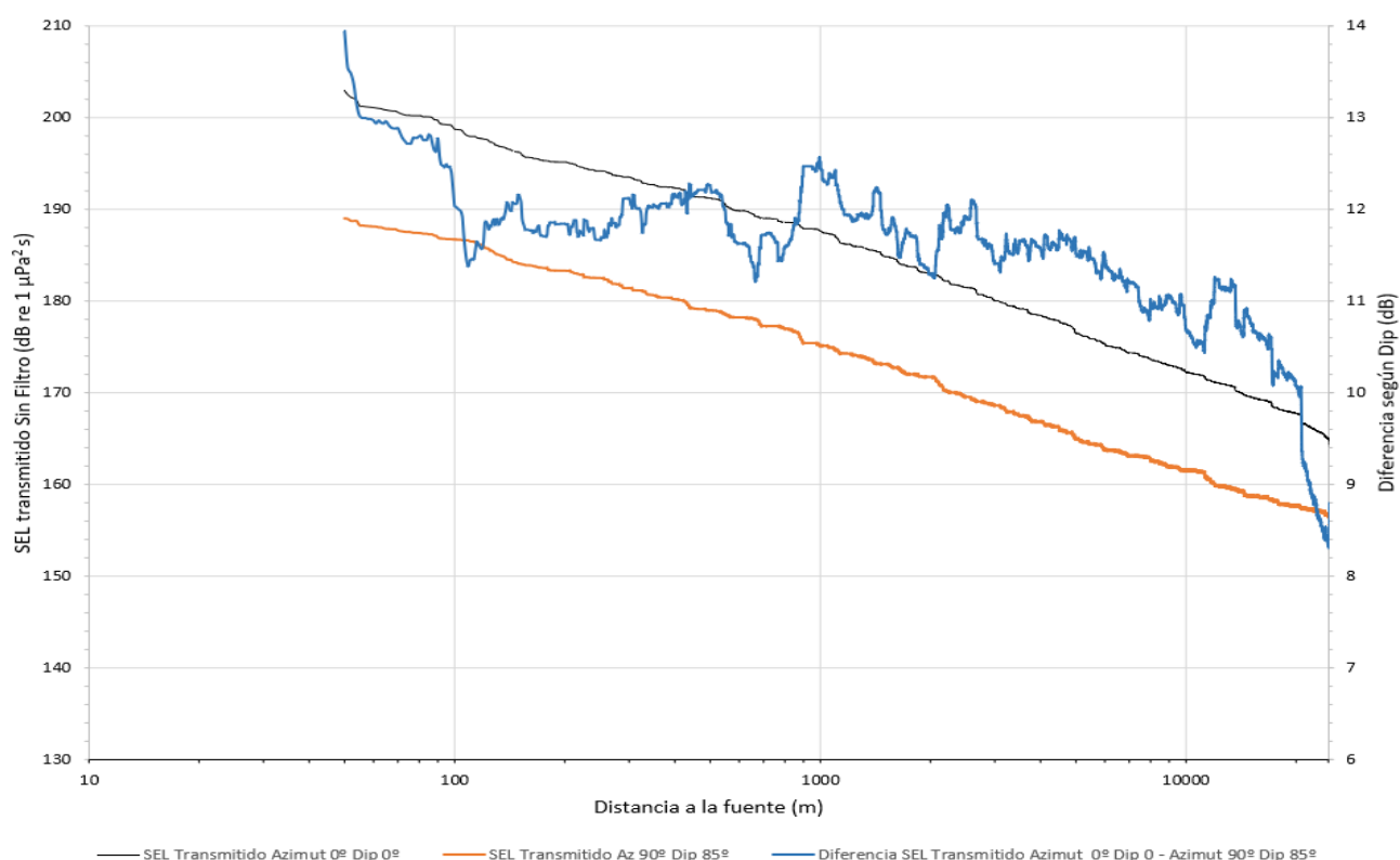
Figura 85. SEL recibido (RL). Profundidad Variable (BV8). Dip 0° - Azimut 90° Dip 85° Sin Filtro
