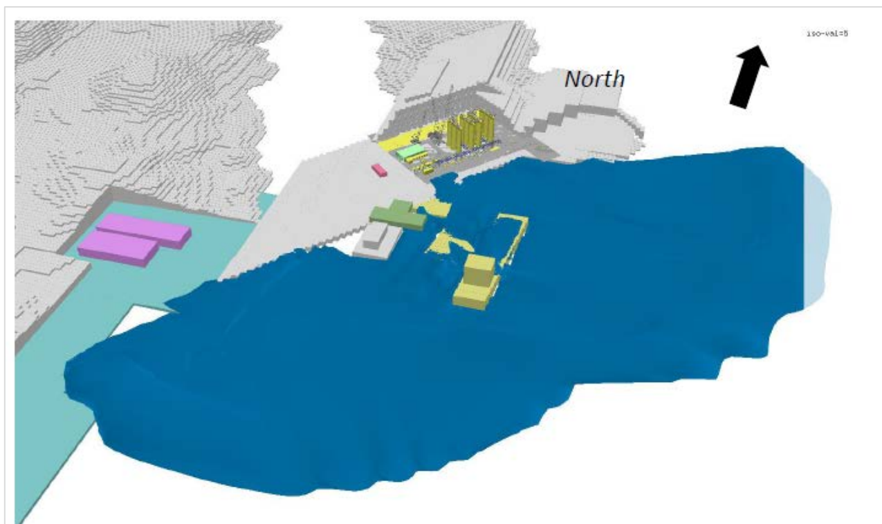
Figur 8-6 Areal som potensielt eksponeres for metan konsentrasjon (≥5 %) gitt en LNG lekkasje fra fartøy ved kai. Forutsetninger: 500 kg/s i 10 min og vindhastighet på 3 m/s fra sørøst (SAFETEC, 2019b)
