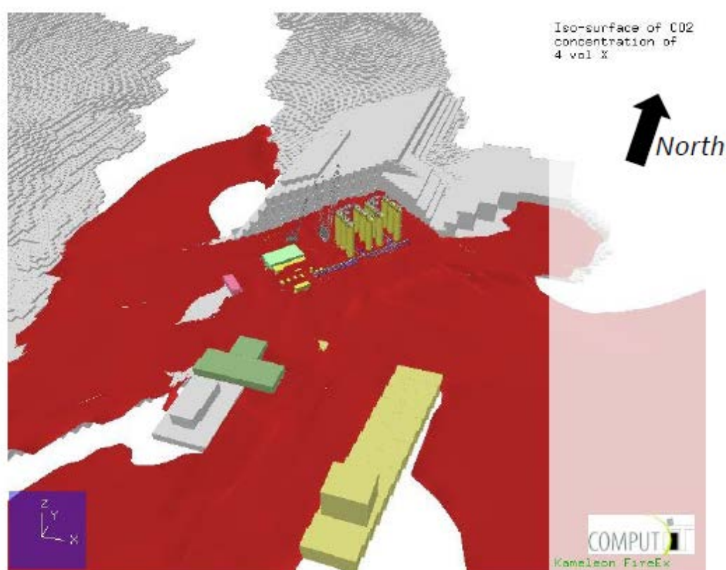
Figur 8-4 Areal som potensielt eksponeres for forhøyet CO 2 konsentrasjon ( \geq 4 %) ved bakkenivå, gitt en lekkasje på 650 kg/s i 10 min som følge av svikt i nødventil til lagringstank. Modelleringen er basert på vindhastighet på 3 m/s fra sørøst (SAFETEC, 2019b)
