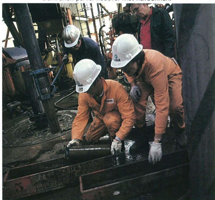
Fra interessante soner tas det steinprøver, såkalte kjerneprøver.
