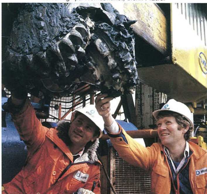
Den første borkronen er en „hullåpner” med diameter 36 tommer.
