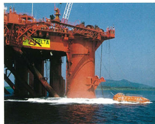
Fritt-fall-livbåten prøves. «Dyvi Delta» som borer for Statoil, er verdens første boreplattform med dette rednings-systemet.
