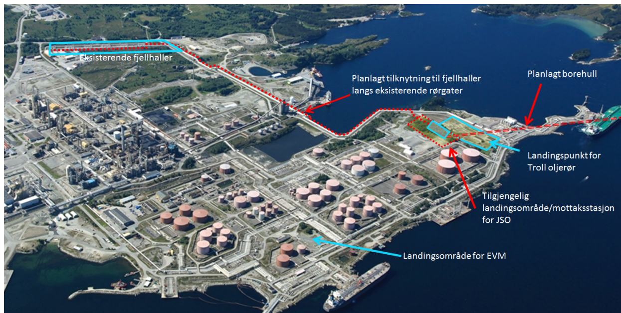
Figur 1.3 Områder for modifikasjoner på Mongstad-terminal knyttet til ilandføring av olje fra Johan Sverdrup er markert med rødt.
