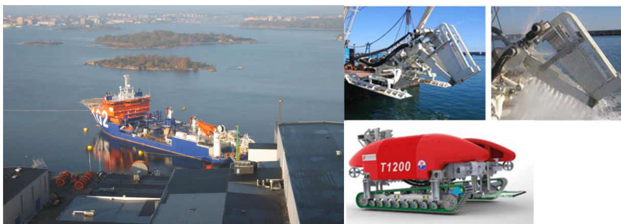
Figur 4-24 Typisk leggefartøy og utstyr for nedspyling av kabler
