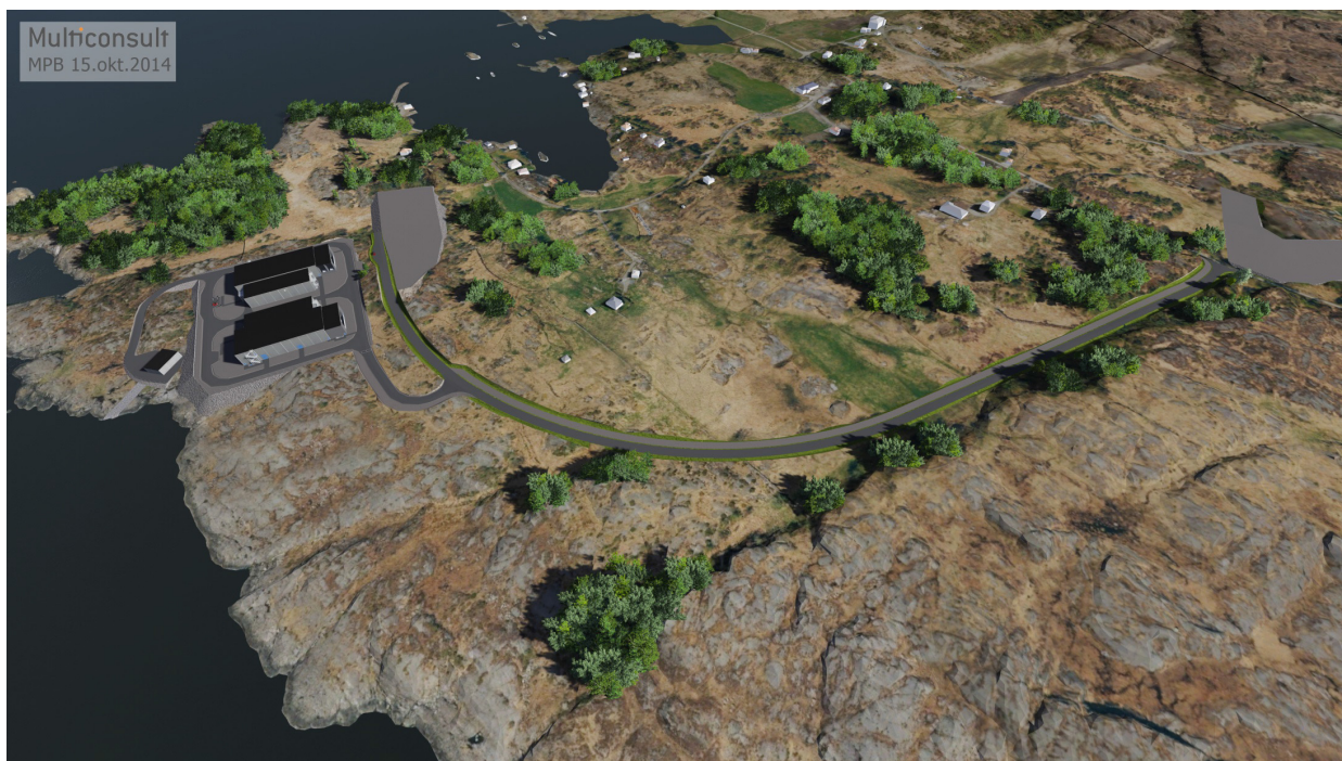
Figur 4-6 Lokalisering av omformerstasjon på Haugsneset, permanent adkomstvei og mulige midlertidige lagringsområder (grå farge)
