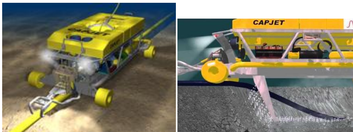
Figur 3-25 Capjet utstyr til nedlegging av kabler i sjøbunn.
