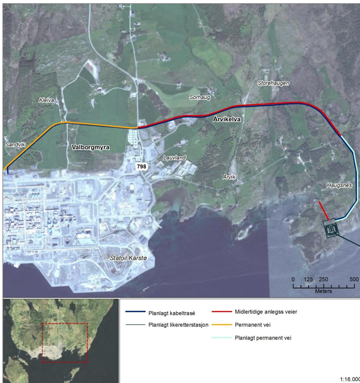
Figur 1-2 Traseen for Utsira kabelen på land og angivelse av lokasjoner som henvist i teksten.
