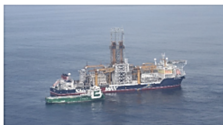
Ejemplo de buque de perforación, con un buque de servicios entregando suministros.
