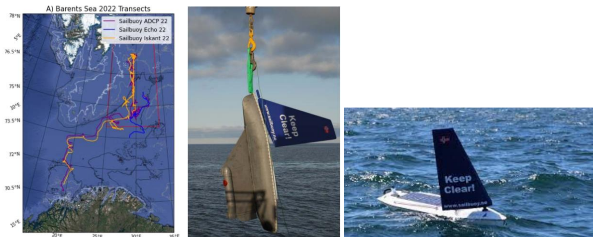
Figur 3-1 Seilingsrute (t.v.) til de 3 autonome farkostene av type Sailbuoy, som ble benyttet i det pågående forskningsprosjektet på økosystemer ved polarfront og iskant
