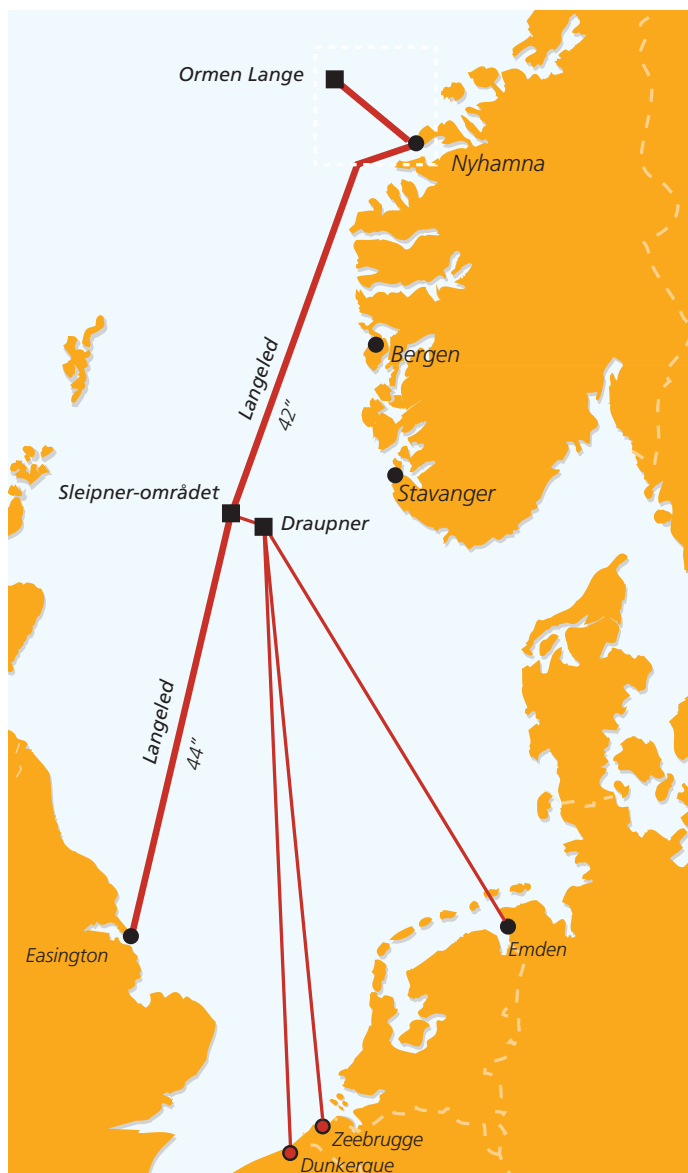
Gassledningen fra Ormen Lange – vil bli lagt via Sleipner på vei til Storbritannia. Sleipner styrker med denne avgjørelsen sin posisjon som gassknutepunkt i Nordsjøen. Gass fra andre felt kan blandes inn i gassen fra Ormen Lange, og gass fra dette feltet kan leveres til andre markeder.
