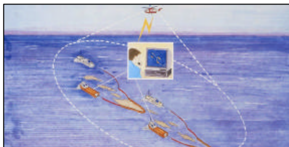
Figur 10-22. Samspill mellom overvåkingshelikopter og oljevern fartøy
