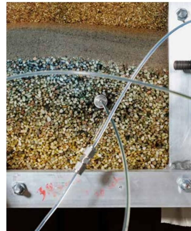
ARMAZENAMENTO DE CO<sub>2</sub> no reservatório modelo estudado por Martin Færnø e seus colegas, o CO<sub>2</sub> é bombeado até o reservatório e armazenado nas camadas geológicas deste, fazendo com que a água existente no reservatório seja expelida.
