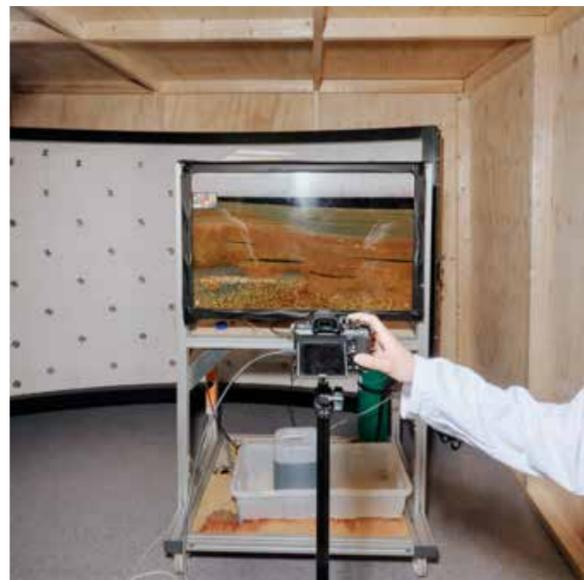
RESERVATÓRIO MODELO: o reservatório modelo permite o estudo dos padrões de fluxo do CO<sub>2</sub> e da água. Com o uso de modelos matemáticos, é possível entender melhor o fluxo e aprimorar o equipamento de simulação.
