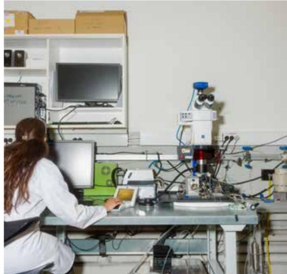
ENSAIOS: aqui são feitos ensaios de armazenamento de carbono em arenito. Com o uso de microscópio, estuda-se a compressão do carbono da água em nível micro, com a finalidade de entender como o mecanismo funciona em pequenos poros. A seguir, o processo é fisicamente aumentado e estudado em uma escala de um metro.
