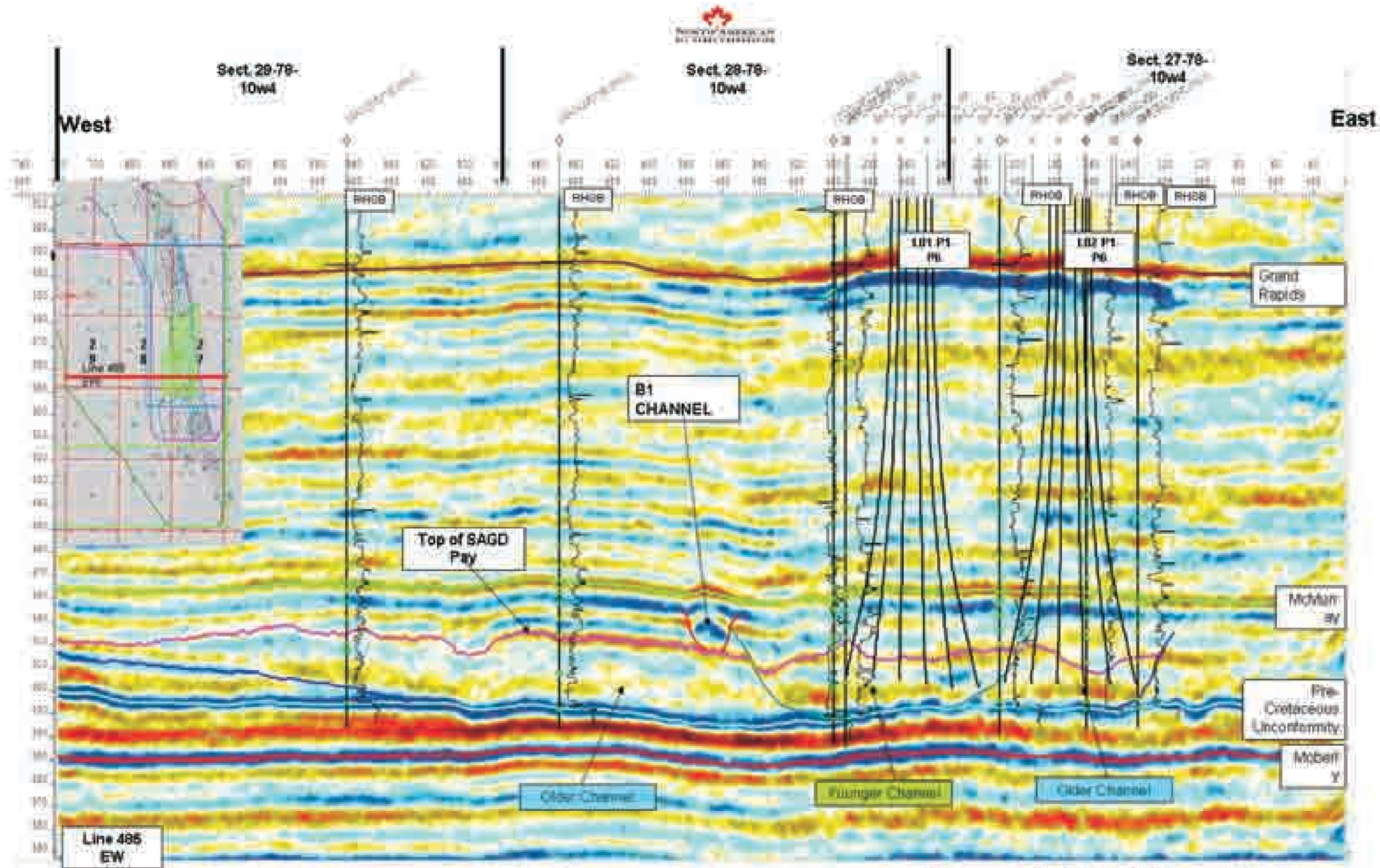
Figure B4.1 - 12 EW Seismic Profile
