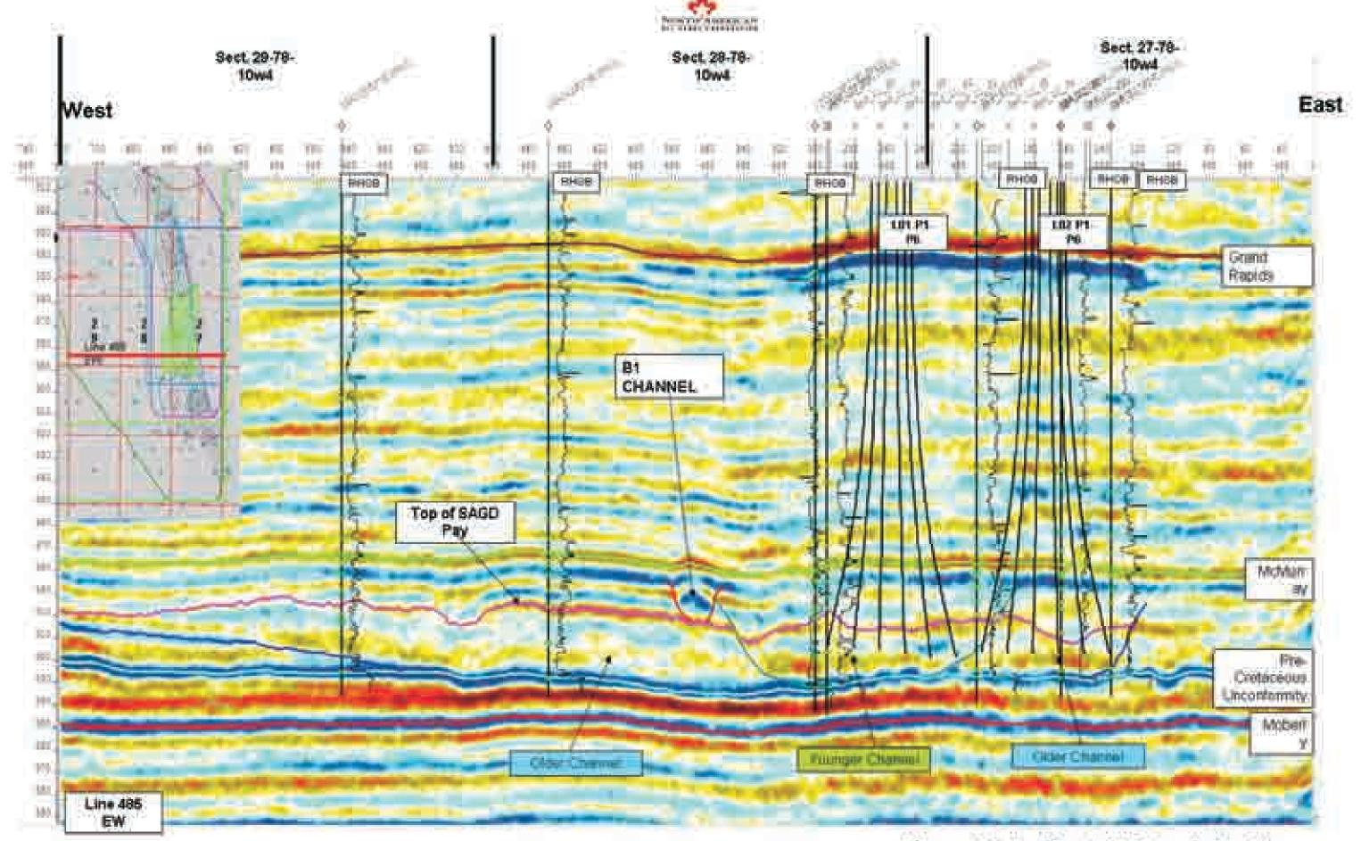
Figure B4.1 - 12 EW Seismic Profile
