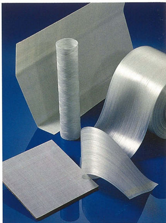
Statoil satses på nytt plastmateriale: PlyTron smelter egenskapene fra glassfiber og polypropen til et sterkt produkt som kan erstatte metaller. Plastmaterialet kan for eksempel brukes i framtidens biler. Statoil Petrokjemie har gjort avtale med patenthaveren for PlyTron, Imperial Chemical Industries. Avtalen sikrer Statoil enerett til produksjon og salg av PlyTron i Europa.
