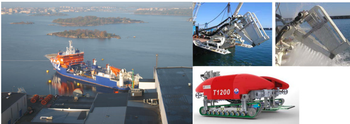
Figur 3-27 Typisk leggefartøy og utstyr for ned-spyling av kabler
