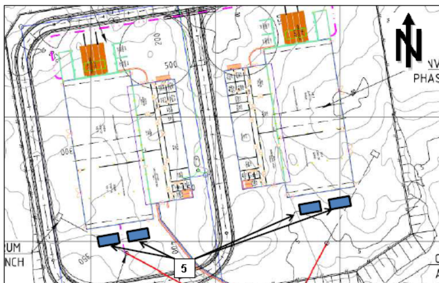
Figur 8-7 Omformerstasjon på Haugsneset. Lokalisering av støykilder ved luftkjøling, ref. «viftepakke» i Tabell 9-3
