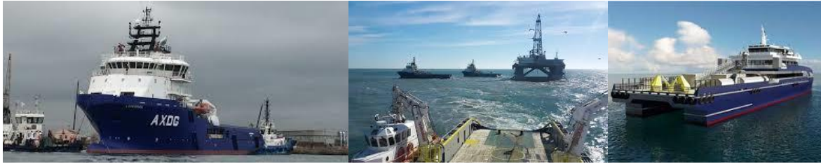
Şəkil 3.6: Soldan sağa, Platformaya təchizat gəmisini, Lövbərlə iş gəmisini, Sürətli heyət gəmisini (Equinor, 2019)
