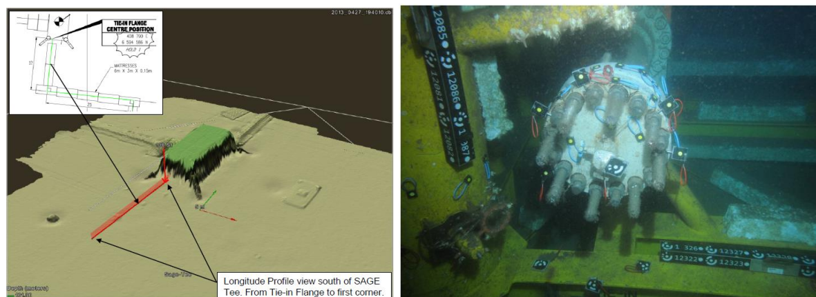
Figur 2.12b. Multistråleekkolodd-bilde av eksisterende Alvheim PLEM, sett fra sørøst. Rød linje viser lokalisering av nordlige del av UHGP fleksibel ekspansjonssløyfe. Stillbilde av eksisterende påkopplingsflens på Alvheim PLEM. Alvheim startet gasseksport til SAGE via Alvheim PLEM i juni 2008.
