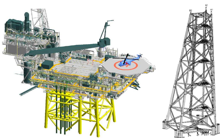
Figur 2-2. Illustrasjon av Huldra-plattformen (venstre) og stålunderstell (høyre).
