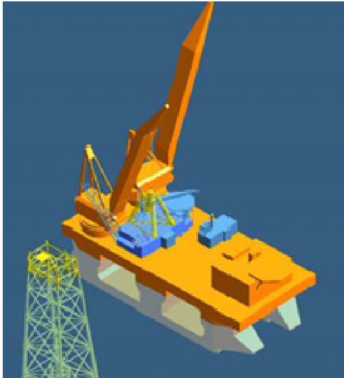
Figur 2-6. Transport av overbygning og kompressor i to moduler på tungløftfartøy.
