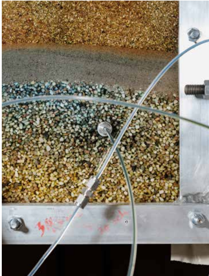
CO 2 -LAGRING: I reservoarmodellen som Martin Færnø og kollegaer studerer, pumpes CO 2 inn i et vannfylt reservoar. Foto: Einar Aslaksen.
