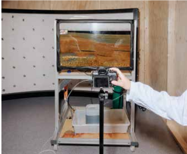
RESERVOARMODELL: Reservoarmodellen muliggjør studier av flytmønstre av CO 2 og vann, og brukes sammen med matematiske modeller for å øke forståelse og forbedre simuleringsverktøy. Foto: Einar Aslaksen.
