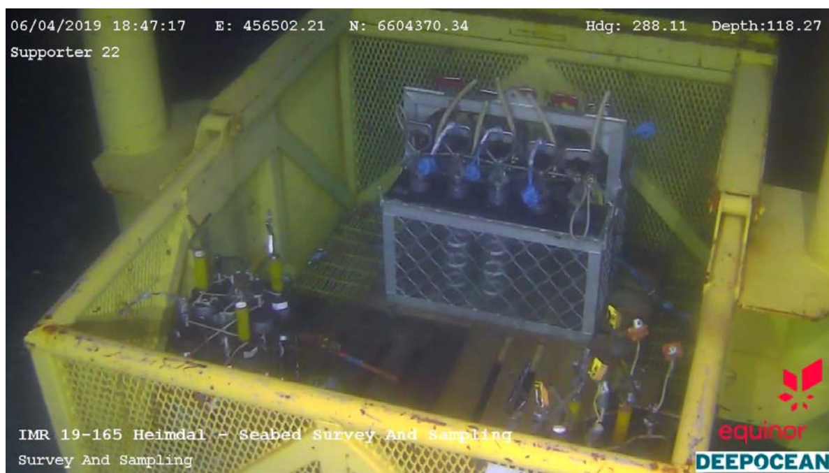
Figur 2-1. Stålkurv ('subsea basket') på sjøbunnen med prøverørstativene stropet fast.
