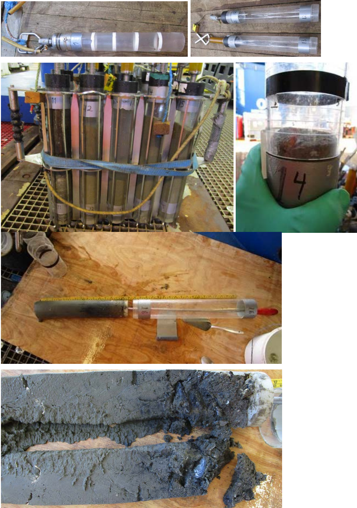
Figur 2-2. Foto av kjerneprøvetagere på dekk og i stativ. Foto av splitting av prøve i sjikt (oppe til høyre) og en prøve (HEM CP 17) lagt for ut for beskrivelse og prøvetaking/seksjonering i sjikt. Nederst er samme prøve delt på langs. Den bestod hovedsakelig av naturlig sjøbunn, med noen blåskjell og mørkere felt på toppen (til høyre i kjernen som vises i nederste bilde).
