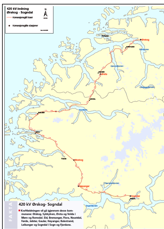
Figur 2.21. Konsesjonsgitt trase for 420 kV kraftledning fra Ørskog (Sunnmøre) – Fardal (Sogndal). (Omarbeidet etter NVE faktaark, www.nve.no )
