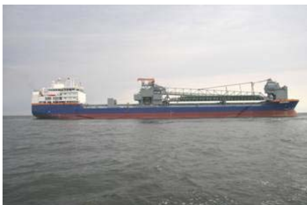
Figur 2.11. Illustrasjonsfoto av steininstallasjonsfartøyet MV "Nordnes".
