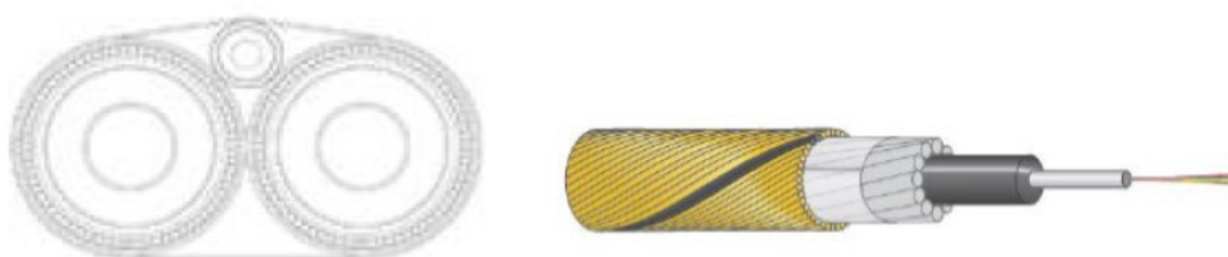
Figur 2 Venstre: Tverrsnitt av kraft- og fiberoptikk kabel som skal gå fra Kvaløya til Wisting (illustrasjon: Equinor). Høyre: Den fiberoptiske del-kabelen (øverst, midt i venstre delfigur) består i likhet med kraftkabelen av en kjerne med flere isolerende og beskyttende lag.
