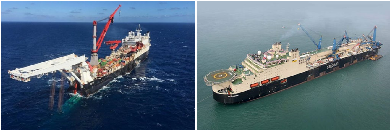
Figur 2-7 Eksempel på typiske rørleggings/installasjonsfartøyer
