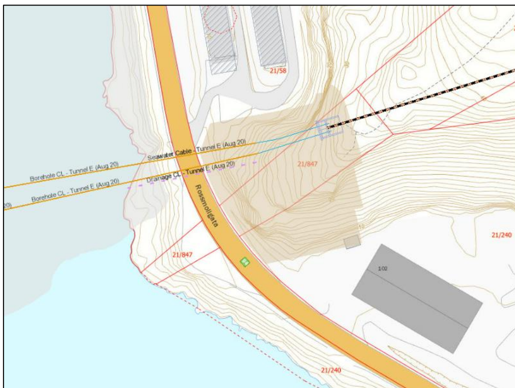
Figur 2-13. Overgang fra kabel i tunnel (stiplet linje) til sjøkabel (heltrukket linje) ved Meland for elektrifiseringen av Hammerfest LNG. Planlagt skjæring lagt i terrasser i fjellknausen Stigen er vist som brunt område til høyre for Rossmollgata. Alternativ B for elektrifiseringen av Wisting medfører kabel i samme tunnel og utføring til sjøkabel fra samme område (sjøkabelen for Wisting er ikke vist).
