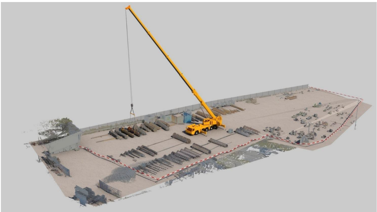
Figur 4-7 Illustrasjon av mobilkranen oppstilt innenfor avsperrt område på inspeksjonsplass (i bakkant er det et permanent gjerde som fungerer som avsperring).
