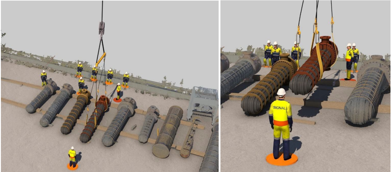
Figur: Varmeveksler ble huket til kran og løftet for inspeksjon
