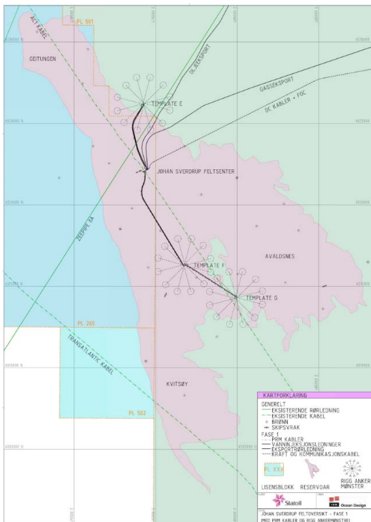
Figur 3-8 Installasjoner, brønnlokasjoner og rørledninger i første utbyggingsfase
