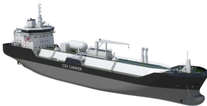
Figur 3-3 Planlagt skip for transport av flytende CO 2 .
